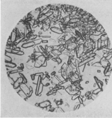
Abb. 1. \text{Na}_3\text{SbS}_3 \cdot 8 \text{H}_2\text{O} (B) 30fach.
